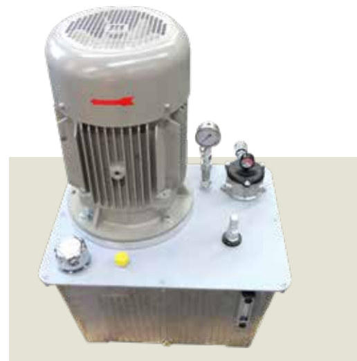
Elektrisches Hydraulikaggregat im Container verbaut
