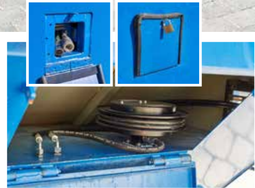
Hydraulikschläuche mit automatischen Schlauchaufroller und abschließbarer Klappe
