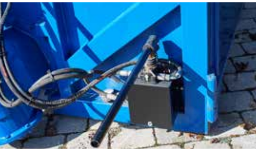
Hydraulische Handpumpe zur Verstellung der Überladehöhe
