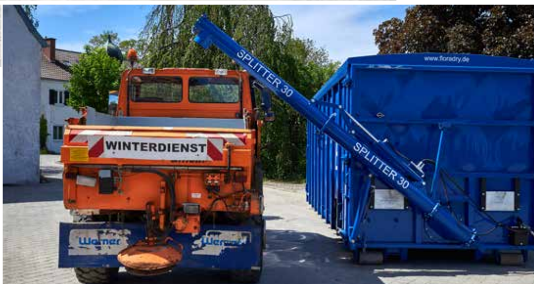
Förderschnecke klappbar mit Höhenverstellung
