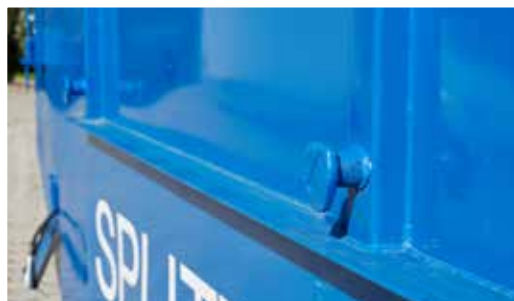
Aufhängezapfen für Absetzcontainer nach DIN 30720
