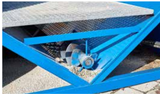
Inliegende Trogförderschnecke mit Lagerung
