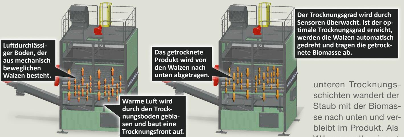
Die Verweildauer des Trocknungsgutes wird in Abhängigkeit von Eingangsfuchte der Biomasse und verfügbarer Trocknungstemperatur sowie Luftmenge auf den gewünschten Trocknungsgrad eingestellt. Ist der Trocknungsgrad erreicht, wird die unterste Schicht der Trocknungsf front durch den beweglichen Trocknungsboden ausgetragen. Gleichzeitig wird die ausgetragene Menge Biomasse mit frischer Biomasse von oben ergänzt. Der Trockner kann somit im quasi-kontinuierlichen Betrieb laufen.
